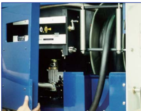
後部機械室に全ての機材をコンパクトに 収納
