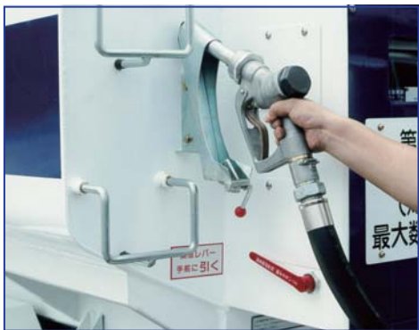
走行中の激しい振動でも外れないワンタッチ収納
